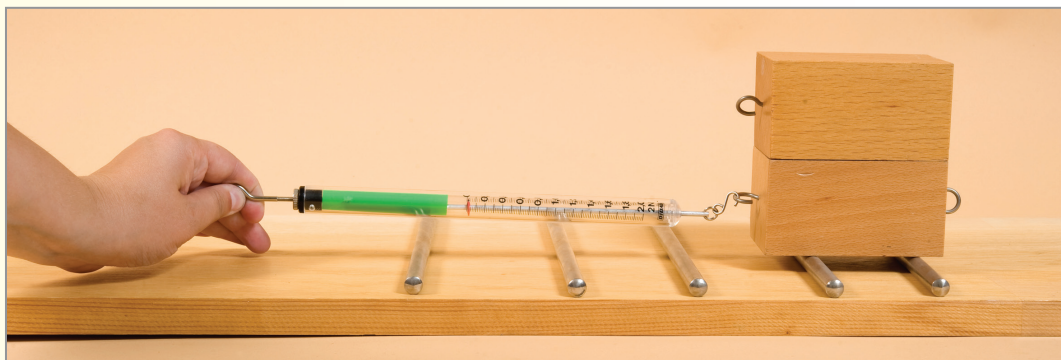
Obr. 102 Meranie trecej sily pri pohybe kvádrov na ceruzkách
