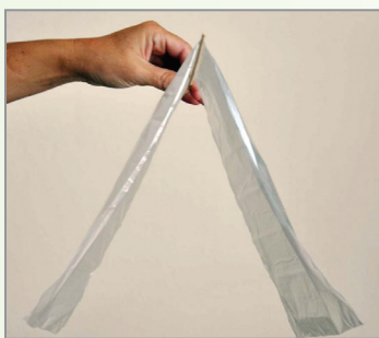
Dva zelektrované pásiky z polyetylénového vrečka sa odpudzujú
