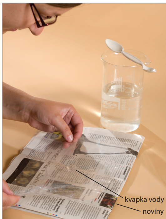
Obr. 3 Pozorovanie písmen pomocou kvapky vody
