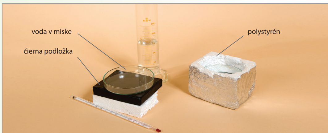
Obr. 5 Príklady zariadení na meranie slnečnej konštanty
