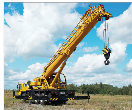
Obr. 121 Praktické využitie pevnej kladky
