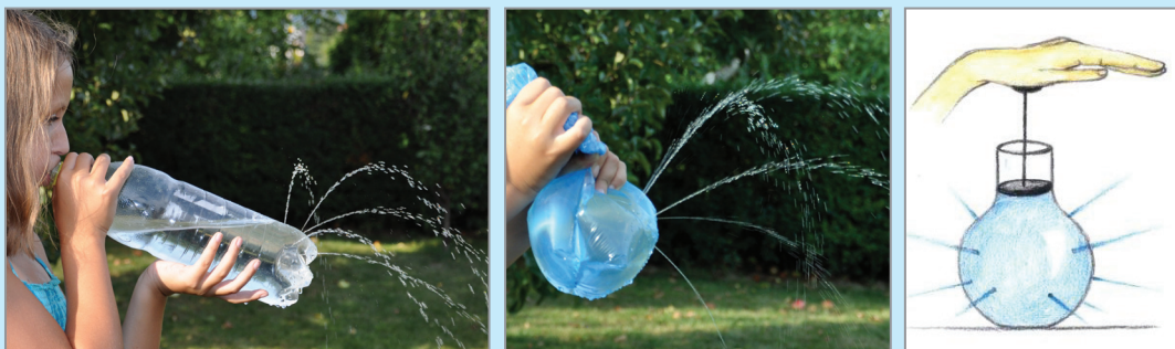
Obr. 85 Pokus na ilustráciu platnosti Pascalovho zákona
