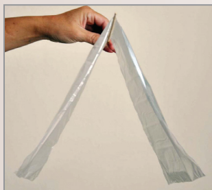
Dva zelektizované pásky z polyetylénového vrečka sa odpudzujú.
